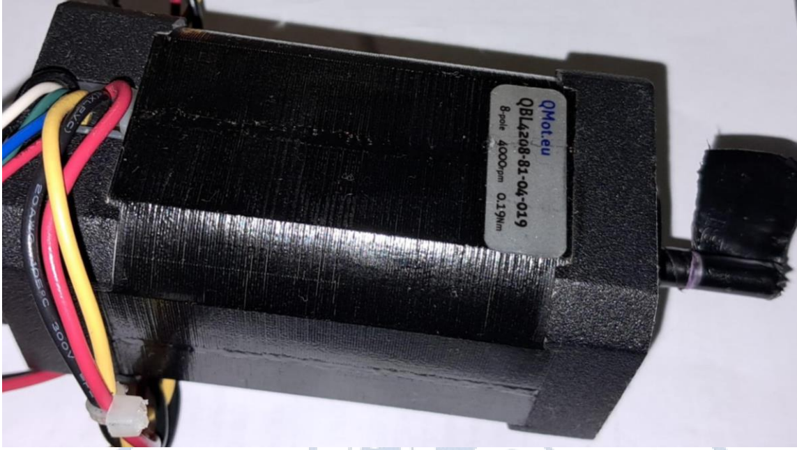
Şekil 35 Sürücü Tasarımında Referans Alınan Motor (QBL 4208)
