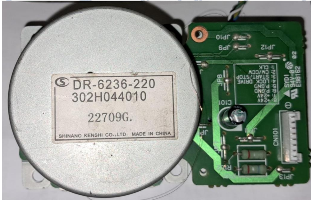
Şekil 34 Hall Sensöründe Hata Bulunan Motor
